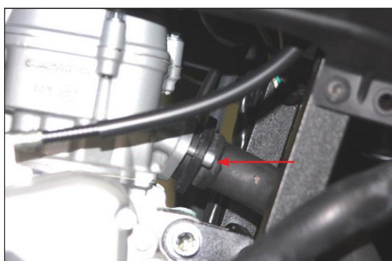
Rimuovere le 2 viti che fissano il collettore al cilindro
