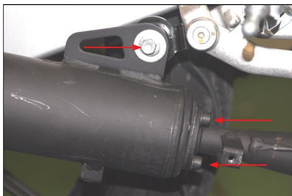
Svitare la vite che sorregge il terminale e le 3 viti sulla flangia dello scarico
