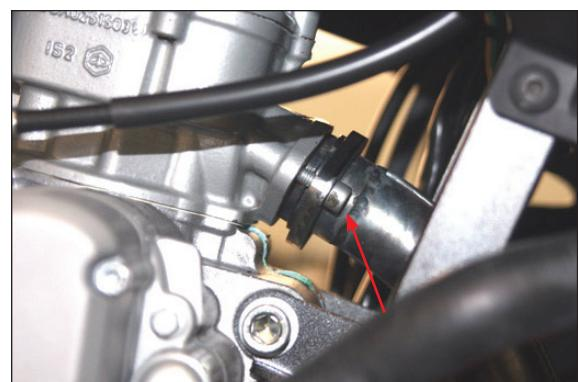
Montare l'espansione Malossi e fissare il collettore al cilindro utilizzando le viti originali
